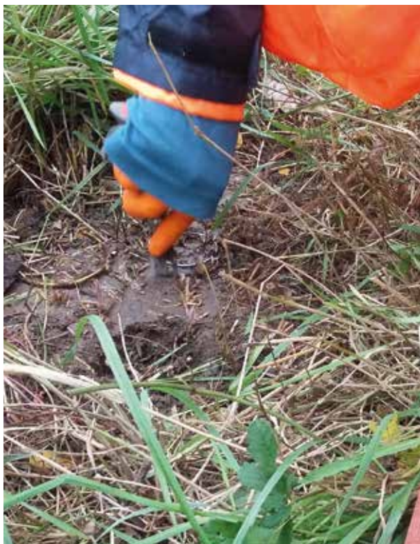
Mesures pédologiques sur un sol construit dans le cadre du programme SITERRE II sur la construction de sols fertiles à partir de matériaux recyclés. © Robin Dagois, Plante & Cité
