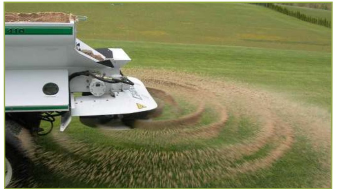
Figure 7 : Photo de projection de sable. Source : BRTMA.
